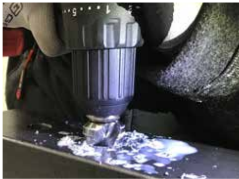
Abbildung 5: Bohrtest. Der BLACK EDITION Akkuschauber fertigte eine Bohrung von bis 26 mm im Durchmesser. Der Marktbegleiter bohrte einen Durchmesser von bis zu 20 mm.
