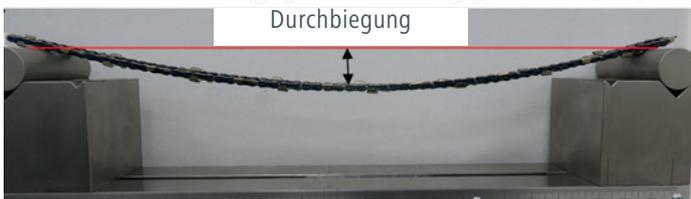
Bild 1: Versuchsaufbau für die Messung der Durchbiegung der Sägeketten
